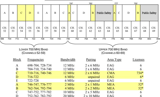
FIGURE 7: ORIGINAL 700 MHz BAND PLAN
